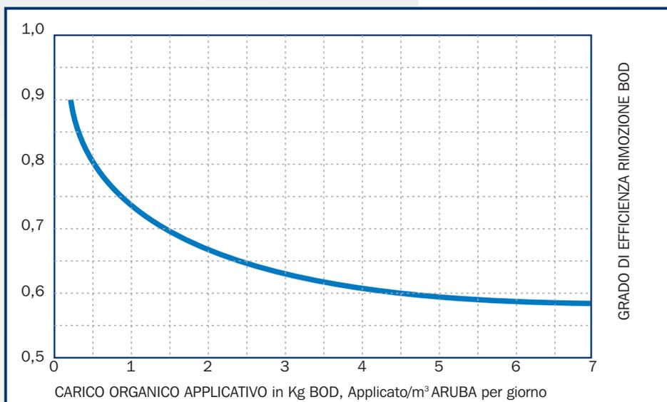
**IMPORTANTE:** superato un certo valore di carico organico applicato, la quantità di BOD5 rimosso resta pressoché costante. questo valore è detto: carico organico critico ed è in funzione della superficie specifica sviluppata dal corpo di riempimento. per ARUBA il carico organico critico assume il valore di circa. 617 kg BOD5 applicato per m<sup>3</sup> di riempimento.
